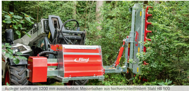
Ausleger seitlich um 1200 mm ausschiebbar. Messerbalken aus hochverschleißfestem Stahl HB 500
