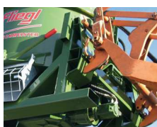
Hydraulischer Antrieb und Laderaufnahme
