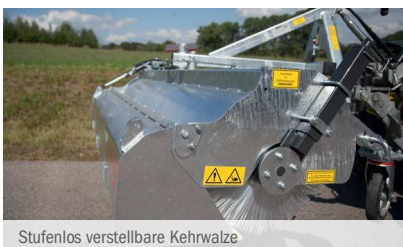
Stufenlos verstellbare Kehrwalze
