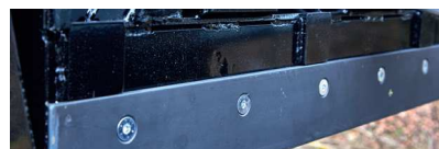
Geschraubte Schürfleiste – keine überstehenden Schrauben
