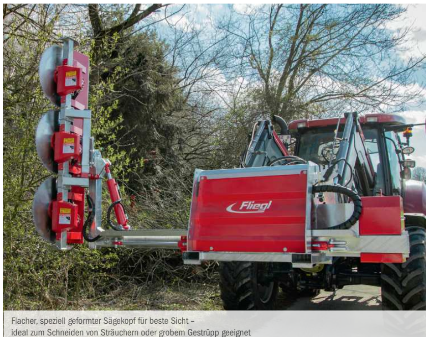
Antrieb der Sägeblätter über Ölmotore
