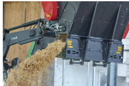
3 Dosierwalzen mit Messern
