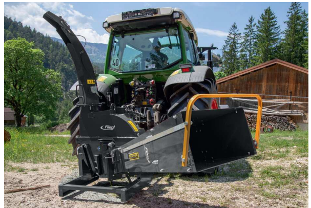
Öffnungswinkel der Auswurfklappe einstellbar
