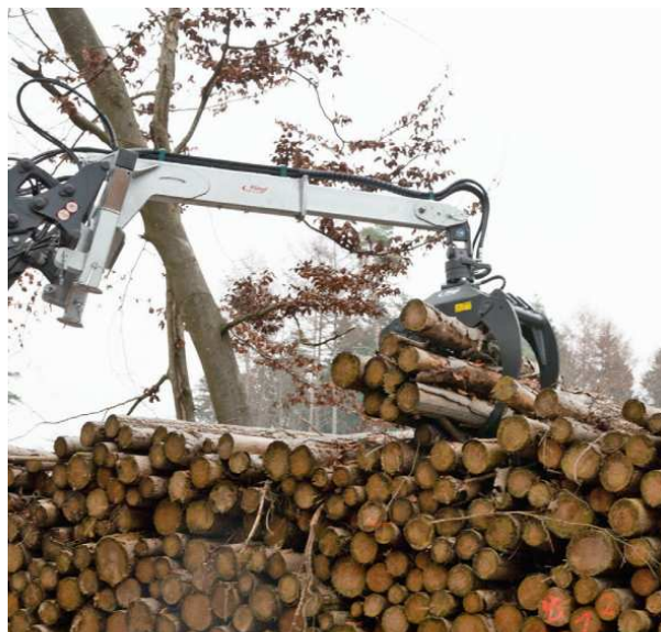
Hydraulische Rückezange »LongNeck Combi-Plus« mit Endlosdrehmotor
