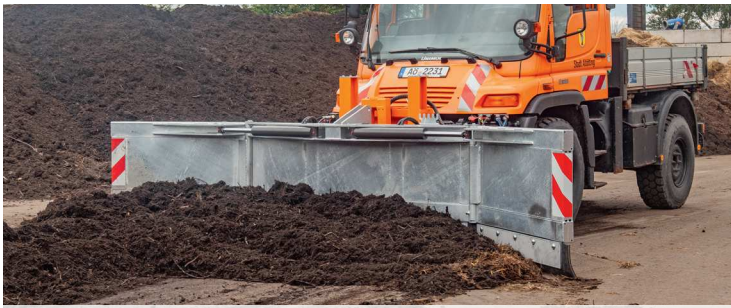
Mit Gummileisten, langlebig dank eingewossenen Stahlseilen
