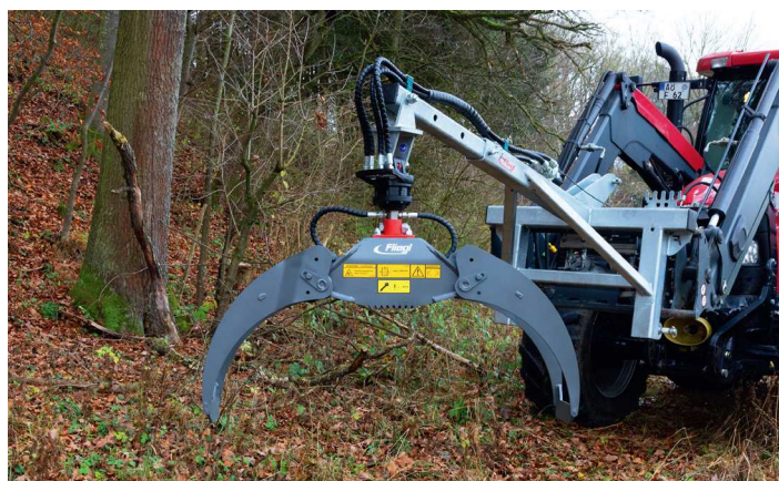
Verladezange mit Lasthakenverlängerung, Drehmotor, Euronorm- und Dreipunktaufnahme
