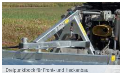
Dreipunktbock für Front- und Heckanbau
