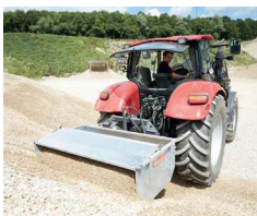
Pendelwand nach oben geklappt
