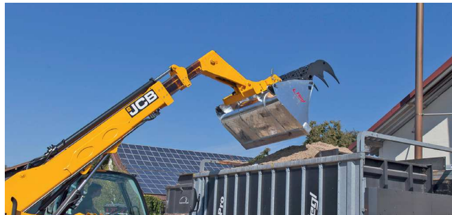
Zinken aus hochverschleißfestem Stahl HB 500 (Stärke 20 mm)
