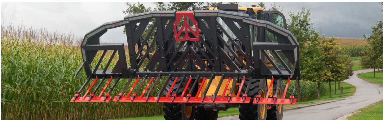
Abb. Siliegabel »Schwerlast« mit Aufsatzschneide für Maissilage
