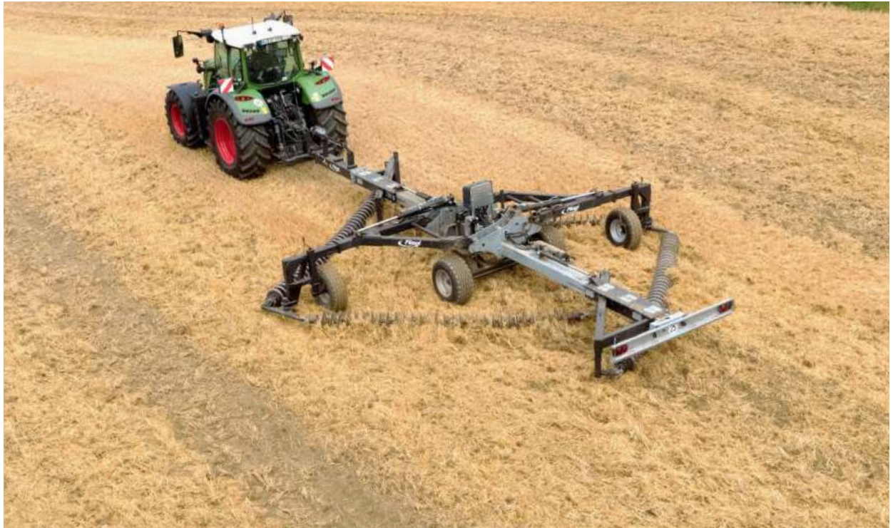
Schwere Ketten mit einstellbarer Bearbeitungsaggressivität von 51° bis 58°
