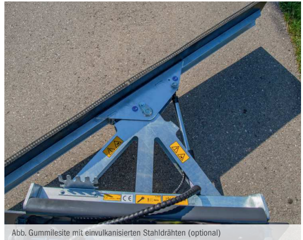
Abb. Gummileiste mit einvulkanisierten Stahldrähten (optional)
