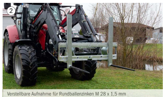
Verstellbare Aufnahme für Rundballenzinken M 28 x 1,5 mm
