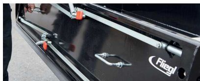
Schnelle und einfache Verriegelung der Klappwand
