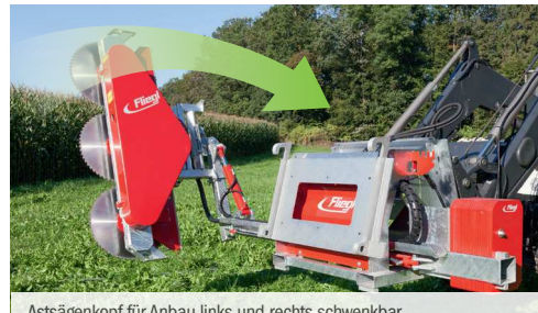
Astsägekopf für Anbau links und rechts schwenkbar
