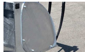
Schaufelkrümmung mit verstärkten Seitenwänden erhöht die Stabilität
