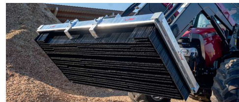
Austauschbare Besenreihen und Abstellkufen für eine schonende Lagerung
