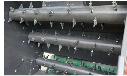
3 Dosierwalzen mit Messern
