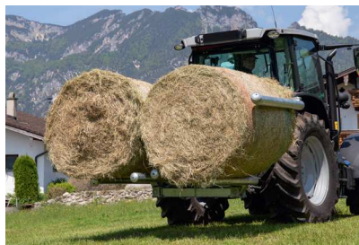
Arbeitsbreite 5-fach jeweils um 50 mm verstellbar
