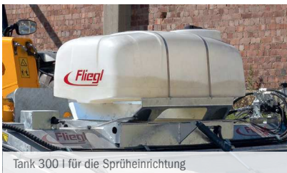
Tank 300 l für die Sprüheinrichtung
