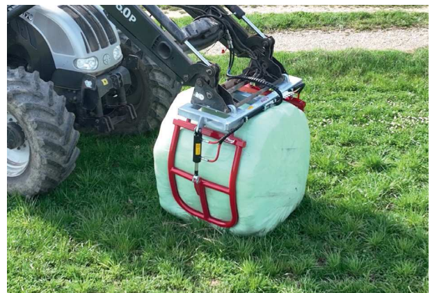
Sicherer Griff, ohne den Ballen zu beschädigen
