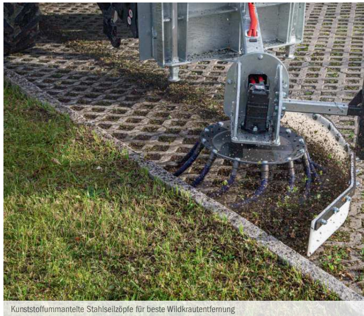
Kunststoffummantelte Stahlseilzöpfe für beste Wildkrautentfernung
