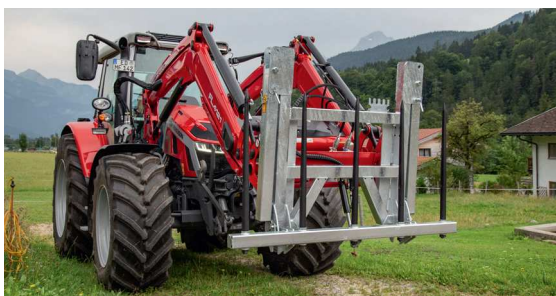
Nach oben geklappte Ballengabel – besonders kompakt
