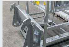
Beispiel: Arbeitsbühne mit schraubbarer Aufnahme für Claas Scorpion
