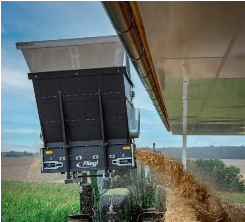
3 Dosierwalzen mit Messern
