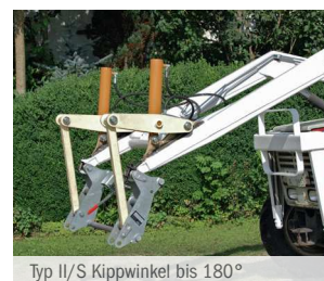
Typ II/S Kippwinkel bis 180°
