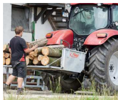
Ausklappbare Pendelwand dient als Wannenverlängerung
