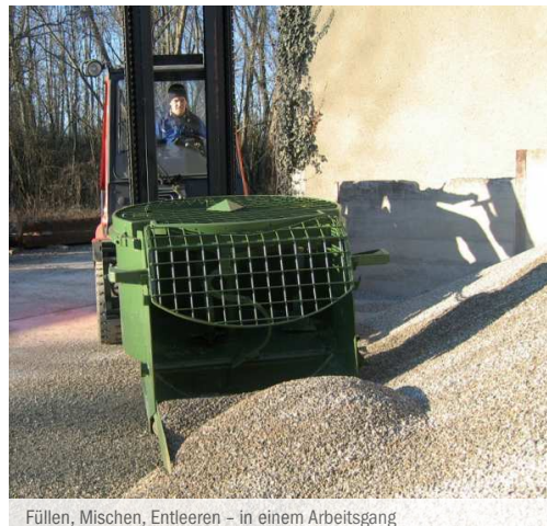
Füllen, Mischen, Entleeren – in einem Arbeitsgang
