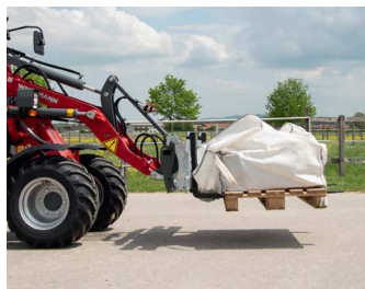
Schutzbügel (optional) zum Schutz gegen Abrutschen von z. B. Holzstapeln, Ballen, Stahlprofilen usw. - einfach und schnell nachrüstbar
