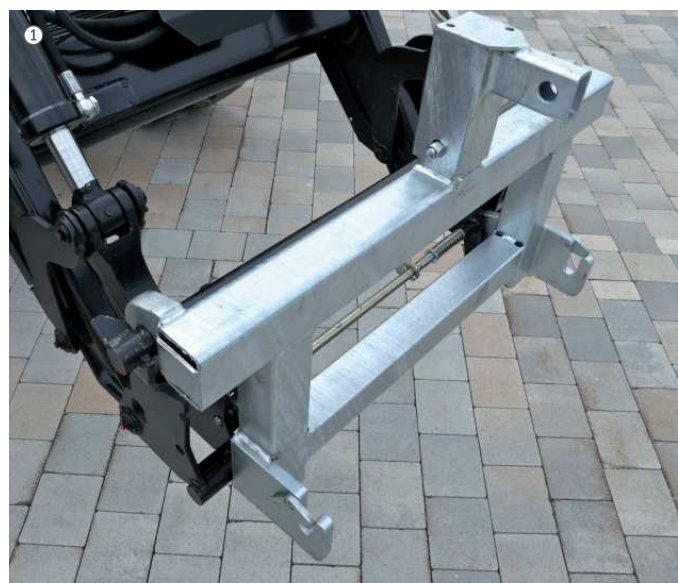
Mit seitlich verstellbarem Ballentransportgerät (nicht im Lieferumfang)
