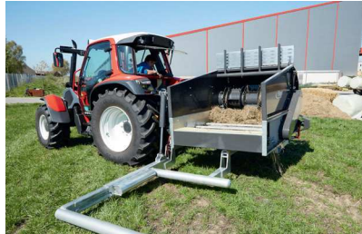
Hydraulische Anpassung des Aufnahmemarms
