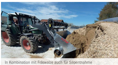
In Kombination mit Fräswalze auch für Siloentnahme
