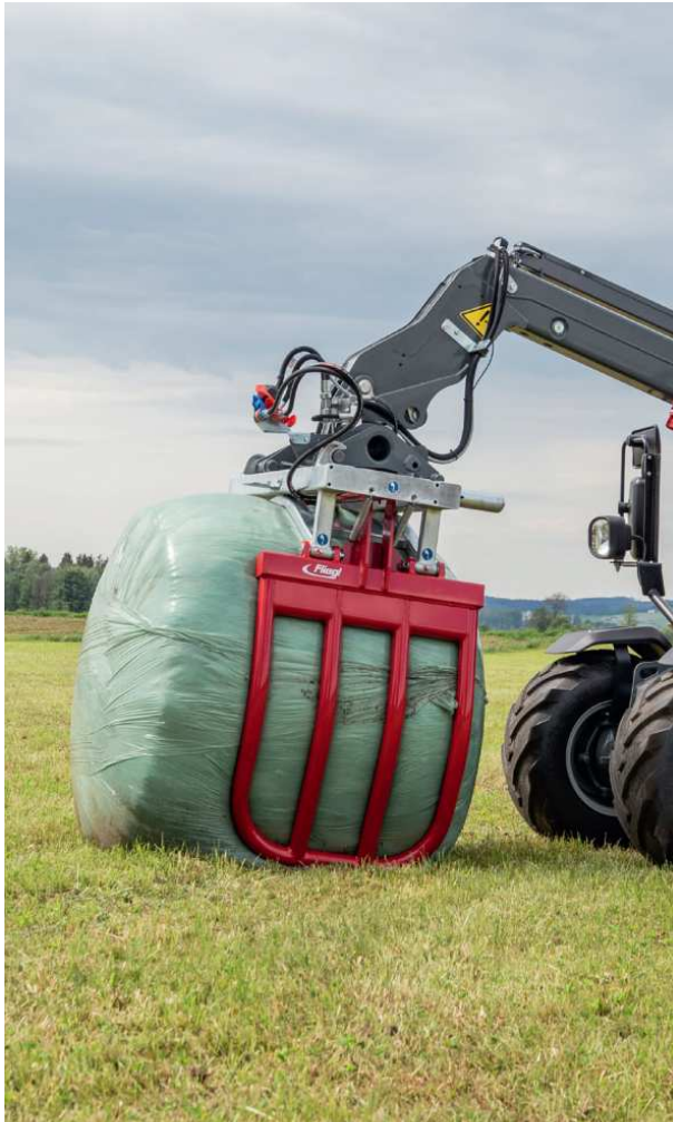
Sicherer Griff, ohne den Ballen zu beschädigen
