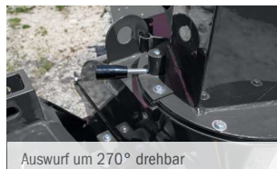
Auswurf um 270° drehbar
