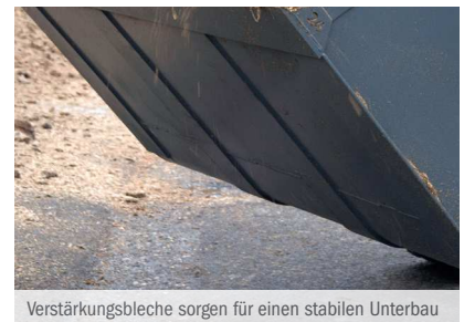
Verstärkungsbleche sorgen für einen stabilen Unterbau
