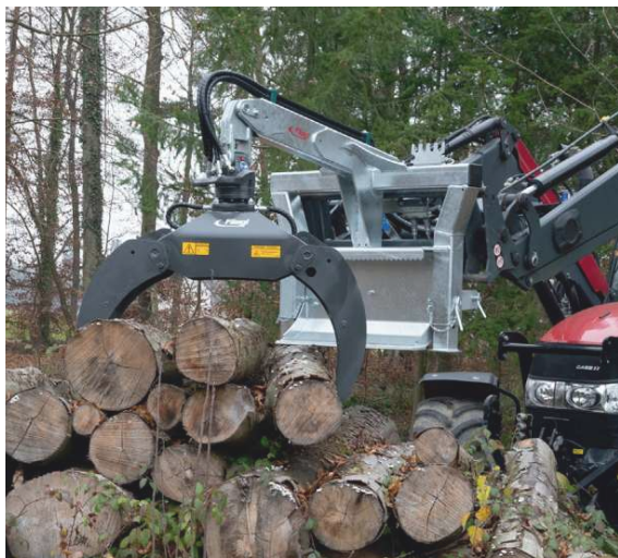
Hydraulische Rückezange »RZ 185 Combi-Plus« mit Polderschild (optional)
