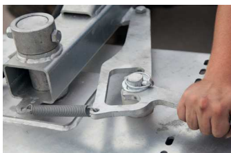
Mechanischer Schwenkbock (30°), optional mit hydraulischem Schwenkbock
