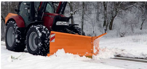
Verzinkt und zusätzlich lackiert für besten Korrosionsschutz
