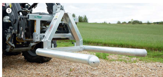
Mit seitlich verstellbarem Ballentransportgerät (nicht im Lieferumfang)
