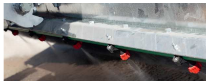
Sprüheinrichtung – die geschützt am Gehäuse angebrachten Spritzschutzdüsen versprühen das Wasser nah an der Bürste und verhindern Staubeentwicklung
