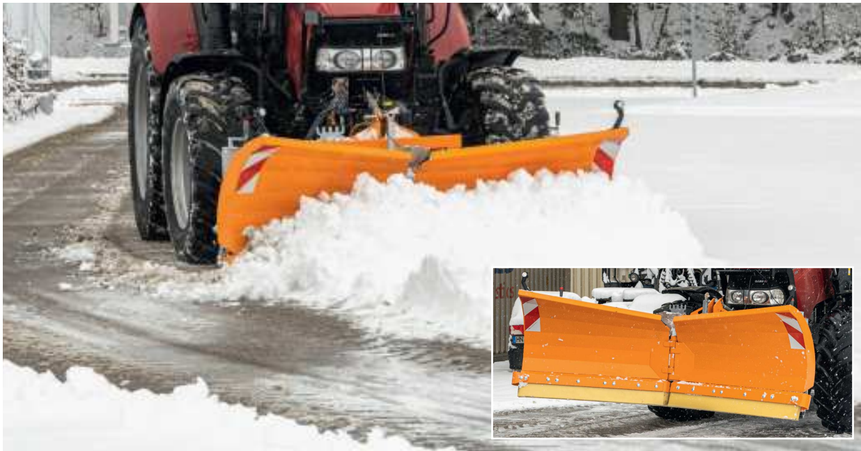
Zwei hydraulisch schwenkbare Flügel mit separater Ansteuerung ermöglichen Winkel-, Pflug- oder V-Stellung
