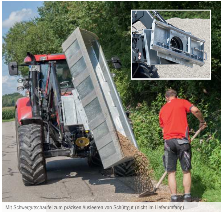
Mit Schwergutschaufel zum präzisen Ausleeren von Schüttgut (nicht im Lieferumfang)
