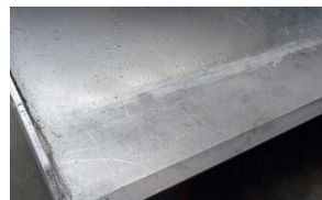
Robuste Schürfleiste schont den Schaufelunterbau
