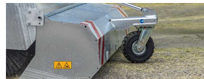
Schwerlast-Stützräder Ø 306 mm – superelastische Vollgummireifen, Breite 105 mm, kugelgelagert, abriebfeste Lauffläche, schwere Drehkranzausführung
