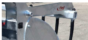
Abschraubbare Seitenwände für erweiterte Einsatzmöglichkeiten, wie z. B. verlustfreier Transport von kurz gehäckselter Silage oder breiigem Dung
