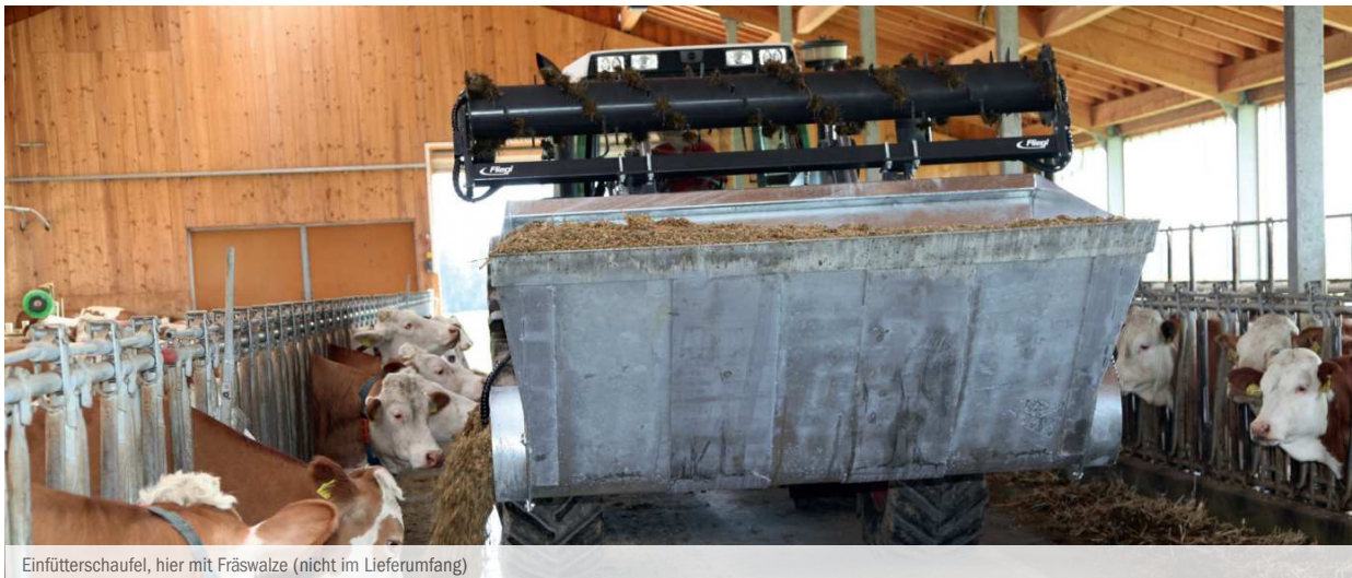
Einfütterschaufel, hier mit Fräswalze (nicht im Lieferumfang)
