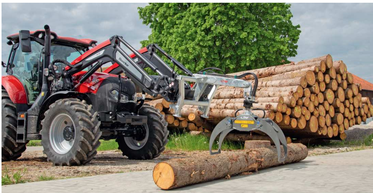
Verladezange mit Lasthakenverlängerung, Drehmotor, Euronorm- und Dreipunktaufnahme
