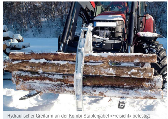
Hydraulischer Greifarm an der Kombi-Staplergabel »Freisicht« befestigt
