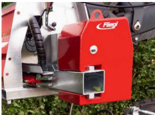
Das seitliche Kontergewicht hilft, einseitige Belastung auf die Schwinge des Trägerfahrzeugs zu reduzieren
