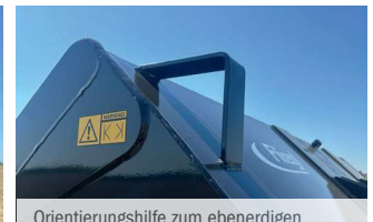
Orientierungshilfe zum ebenerdigen Aufladen von Schüttgut
