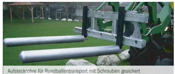
Aufsteckrohre für Rundballentransport mit Schrauben gesichert
