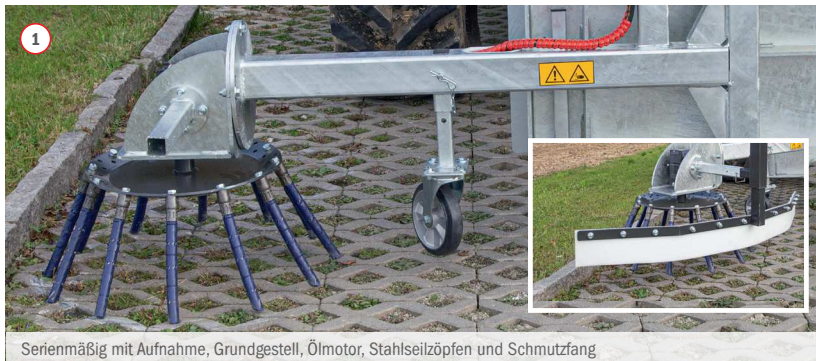
1 Serienmäßig mit Aufnahme, Grundgestell, Ölmotor, Stahlseilzöpfen und Schmutzfang
