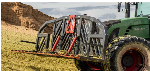
Abb. Siliegabel »Schwerlast« mit Aufsatzschneide für Maissilage
