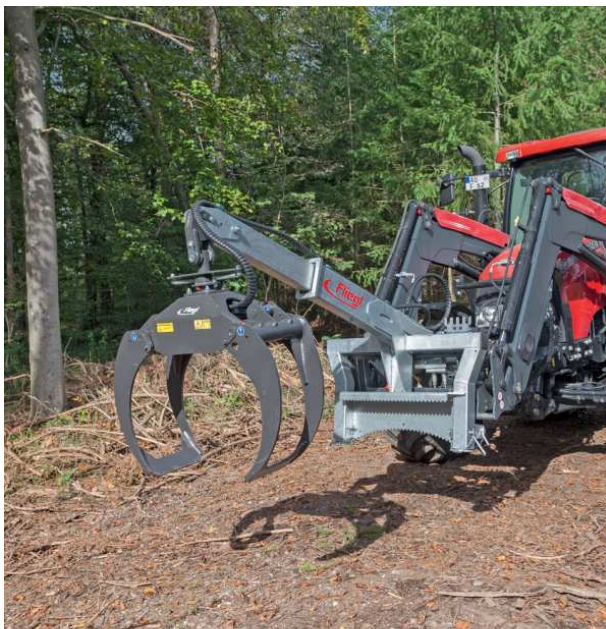
Hydraulische Rückezange »LongNeck Combi« mit mechanischem Drehgelenk
