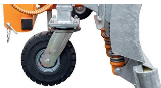
Schwerlast-Stützräder mit superelastischen Vollgummireifen: Ø 306 mm, Breite 105 mm, kugelgelagert, abriebfeste Lauffläche, schwere Drehkranzausführung, verstellbare Spindel
