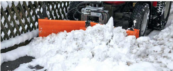
2 hydraulisch schwenkbare Flügel mit separater Ansteuerung
