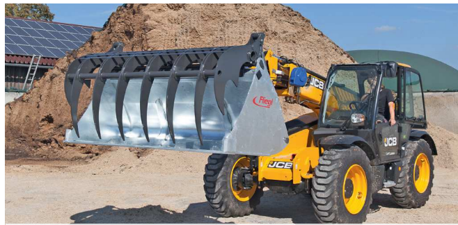
Zinken aus hochverschleißfestem Stahl HB 500 (Stärke 20 mm)
