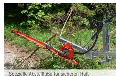
Spezielle Abstellfüße für sicheren Halt
