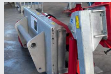
Beispiel: Astsäge mit schraubbarer Aufnahme für Manitou
