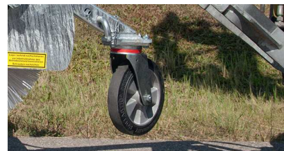
Stabile Lenkrollen Ø 250 mm
