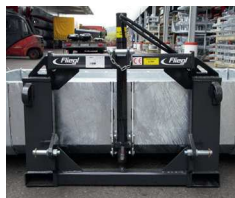
Kombinierte Euronorm-, Dreipunkt- und Stapleraufnahme
