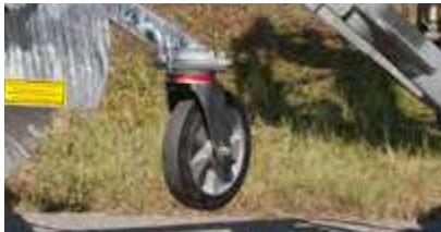
Stabile Lenkrollen Ø 250 mm
