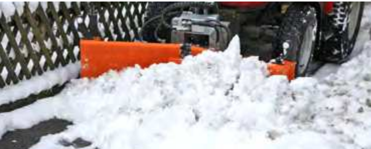
2 hydraulisch schwenkbare Flügel mit separater Ansteuerung
