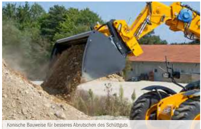
Konische Bauweise für besseres Abrutschen des Schüttguts
