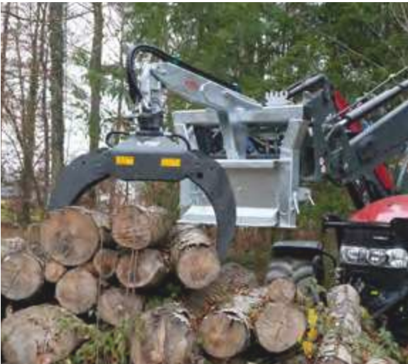
Hydraulische Rückezange »RZ 185 Combi-Plus« mit Polderschild (optional)
