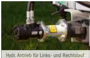
Hydr. Antrieb für Links- und Rechtslauf
