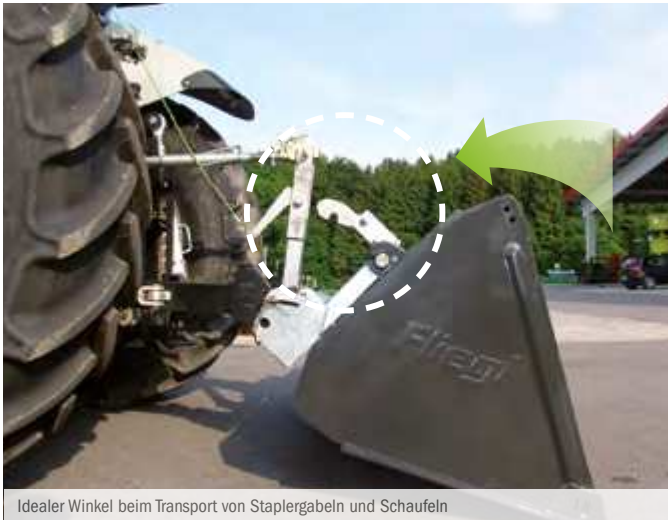
Idealer Winkel beim Transport von Staplergabeln und Schaufeln
