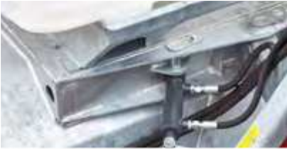
Hydraulischer Schwenkbock inkl. Bedienpult
