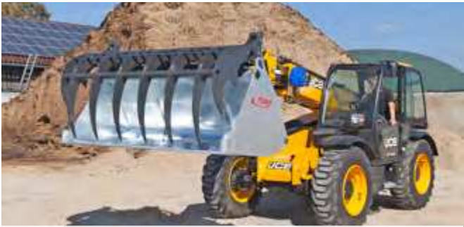
Zinken aus hochverschleißfestem Stahl HB 500 (Stärke 20 mm)
