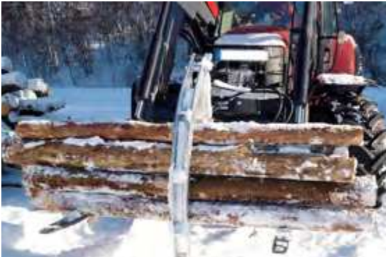
Hydraulischer Greifarm an der Kombi-Staplergabel »Freisicht« befestigt
