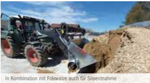
In Kombination mit Fräswalze auch für Siloentnahme
