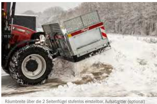
Räumbreite über die 2 Seitenflügel stufenlos einstellbar, Aufsatzgitter (optional)
