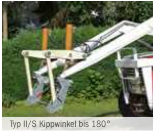
Typ II/S Kippwinkel bis 180°
