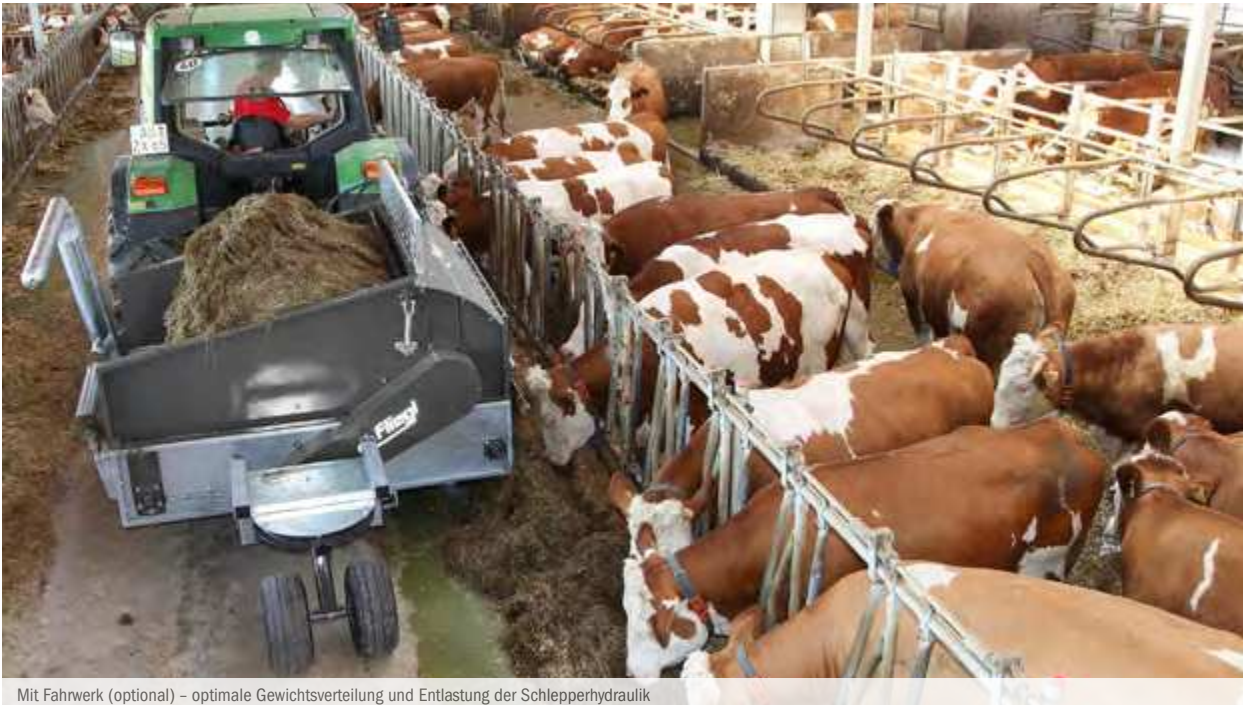
Mit Fahrwerk (optional) – optimale Gewichtsverteilung und Entlastung der Schlepperhydraulik
