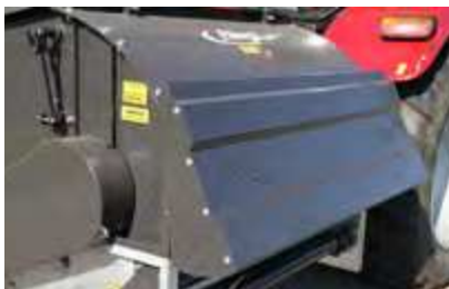
Hydraulischer Deckel – bester Schutz vor Verletzungen
