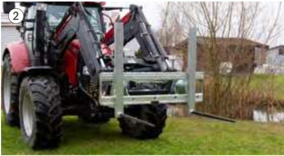
Verstellbare Aufnahme für Rundballenzinken M 28 x 1,5 mm
