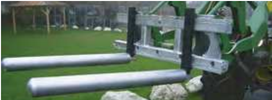
Aufsteckrohre für Rundballentransport mit Schrauben gesichert
