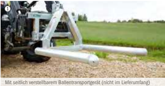
Mit seitlich verstellbarem Ballentransportgerät (nicht im Lieferumfang)
