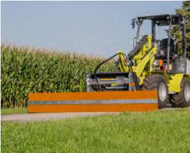
Abb. Gummileiste mit einvulkanisierten Stahldrähten (optional)
