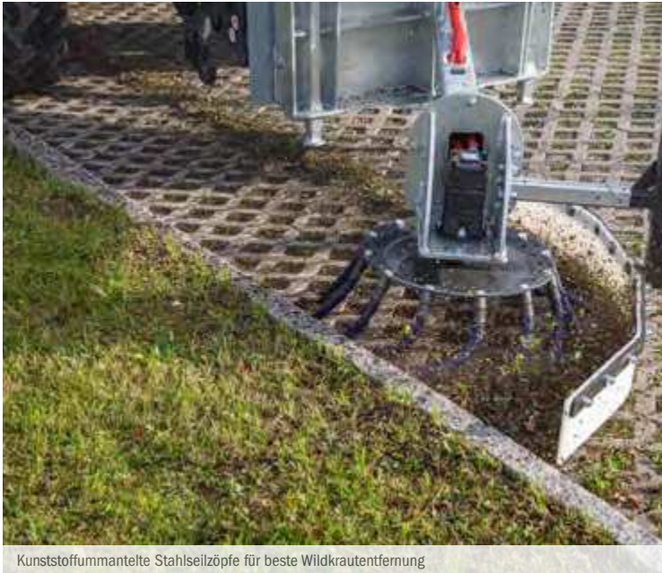
Kunststoffummantelte Stahlseilzöpfe für beste Wildkrautentfernung
