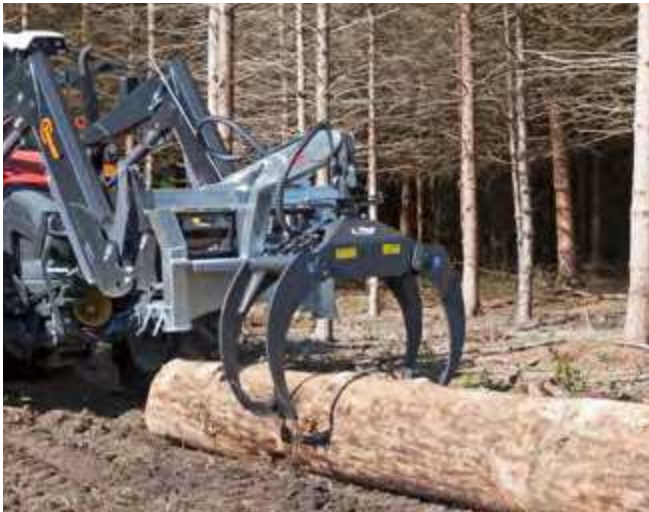
Hydraulische Rückezange »RZ 185 Combi« mit mechanischem Drehgelenk
