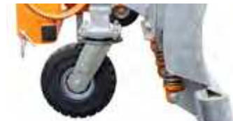
Schwerlast-Stützräder mit superelastischen Vollgummireifen: Ø 306 mm, Breite 105 mm, kugellagert, abriebfeste Lauffläche, schwere Drehkranzausführung, verstellbare Spindel
