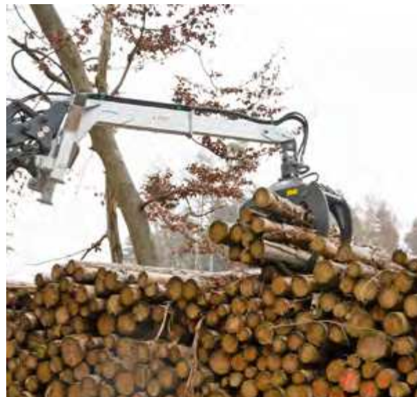
Hydraulische Rückezange »LongNeck Combi-Plus« mit Endlosdrehmotor
