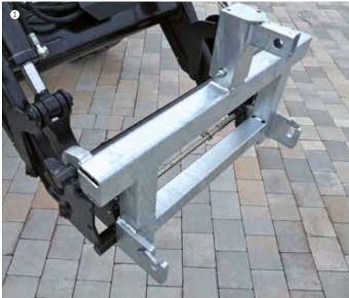
Mit seitlich verstellbarem Ballentransportgerät (nicht im Lieferumfang)
