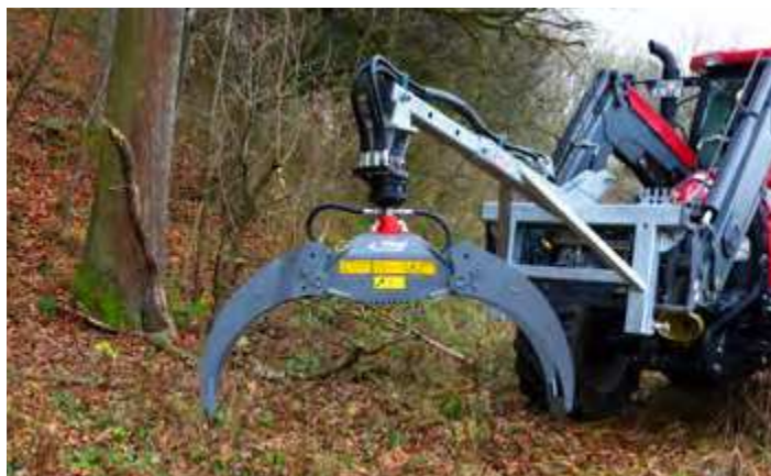
Verladezange mit Lasthakenverlängerung, Drehmotor, Euronorm- und Dreipunktaufnahme
