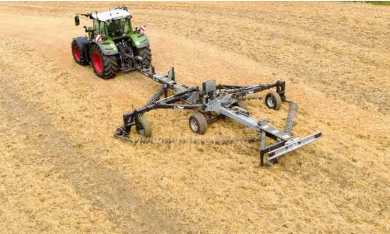
Schwere Ketten mit einstellbarer Bearbeitungsaggressivität von 51° bis 58°
