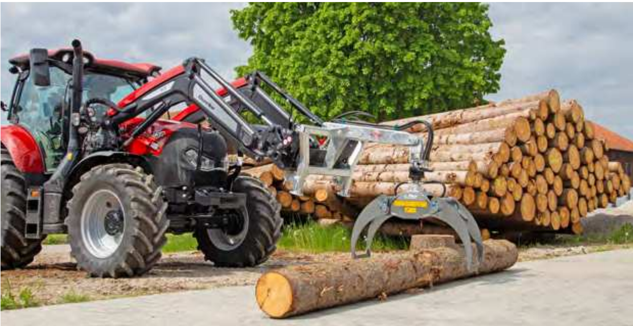
Verladezange mit Lasthakenverlängerung, Drehmotor, Euronorm- und Dreipunktaufnahme
