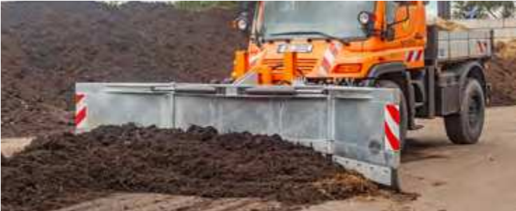
Mit Gummileisten, langlebig dank eingegossenen Stahlseilen
