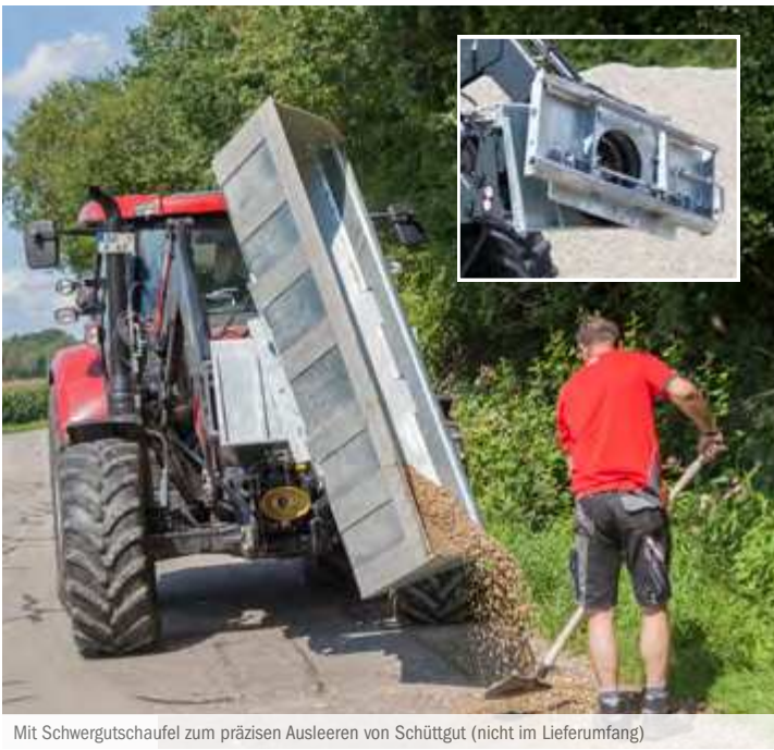
Mit Schwergutschaukel zum präzisen Ausleeren von Schüttgut (nicht im Lieferumfang)
