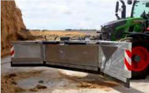
Flexible Anwendung, dank hydraulischer Schwenkfunktion
