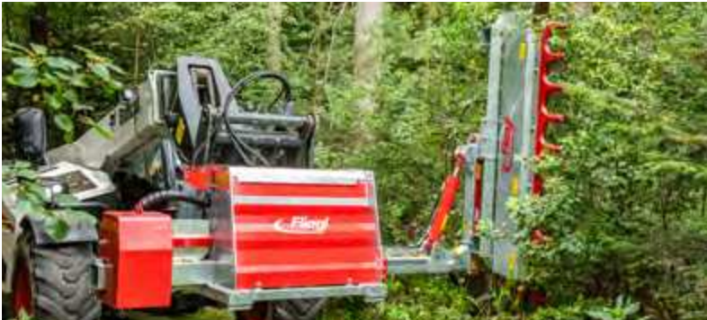
Ausleger seitlich um 1200 mm ausschiebbar. Messerbalken aus hochverschleißfestem Stahl HB 500
