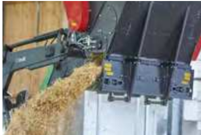
3 Dosierwalzen mit Messern
