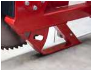
Schutzbügel verhindert Bodenkontakt des untersten Sägeblatts.
