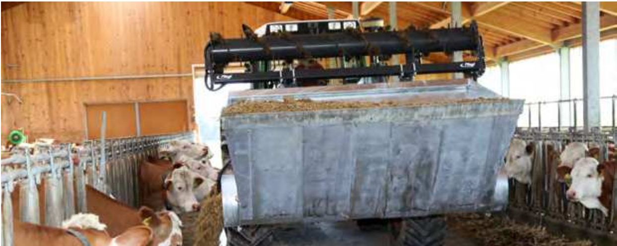
Einfütterschaufel, hier mit Fräswalze (nicht im Lieferumfang)
