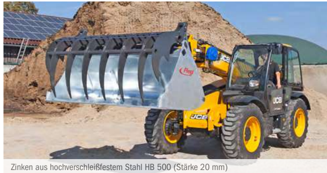
Zinken aus hochverschleißfestem Stahl HB 500 (Stärke 20 mm)
