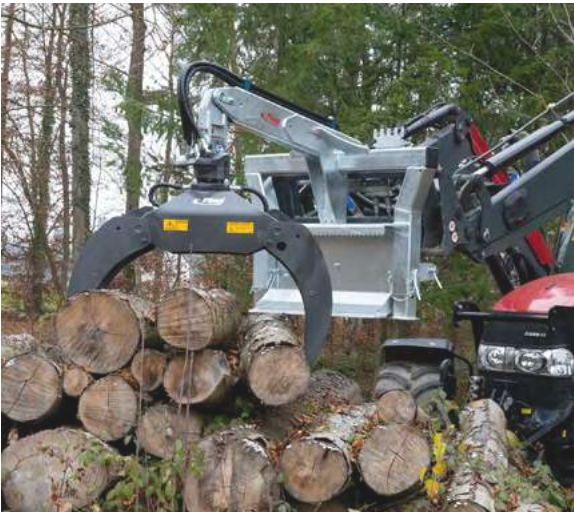
Hydraulische Rückezange »RZ 185 Combi-Plus« mit Polderschild (optional)
