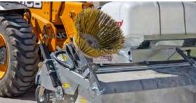
Mechanisch klappbarer Seitenbesen
