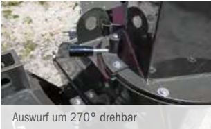
Auswurf um 270° drehbar
