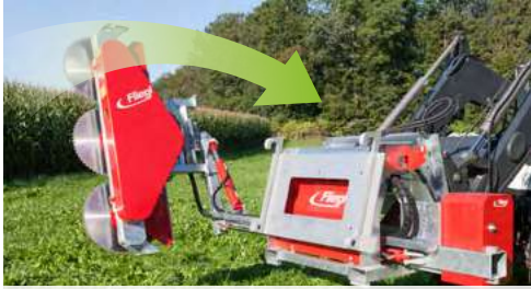
Astsägenkopf für Anbau links und rechts schwenkbar
