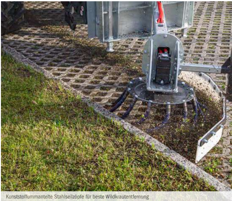
Kunststoffummantelte Stahlseilzöpfe für beste Wildkrautentfernung
