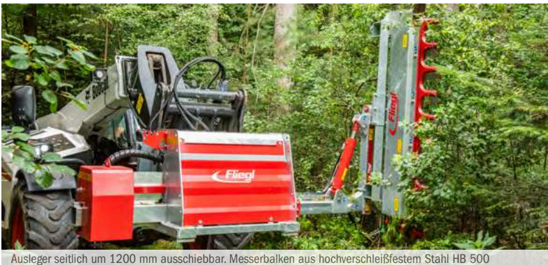
Ausleger seitlich um 1200 mm ausschiebbar. Messerbalken aus hochverschleißfestem Stahl HB 500
