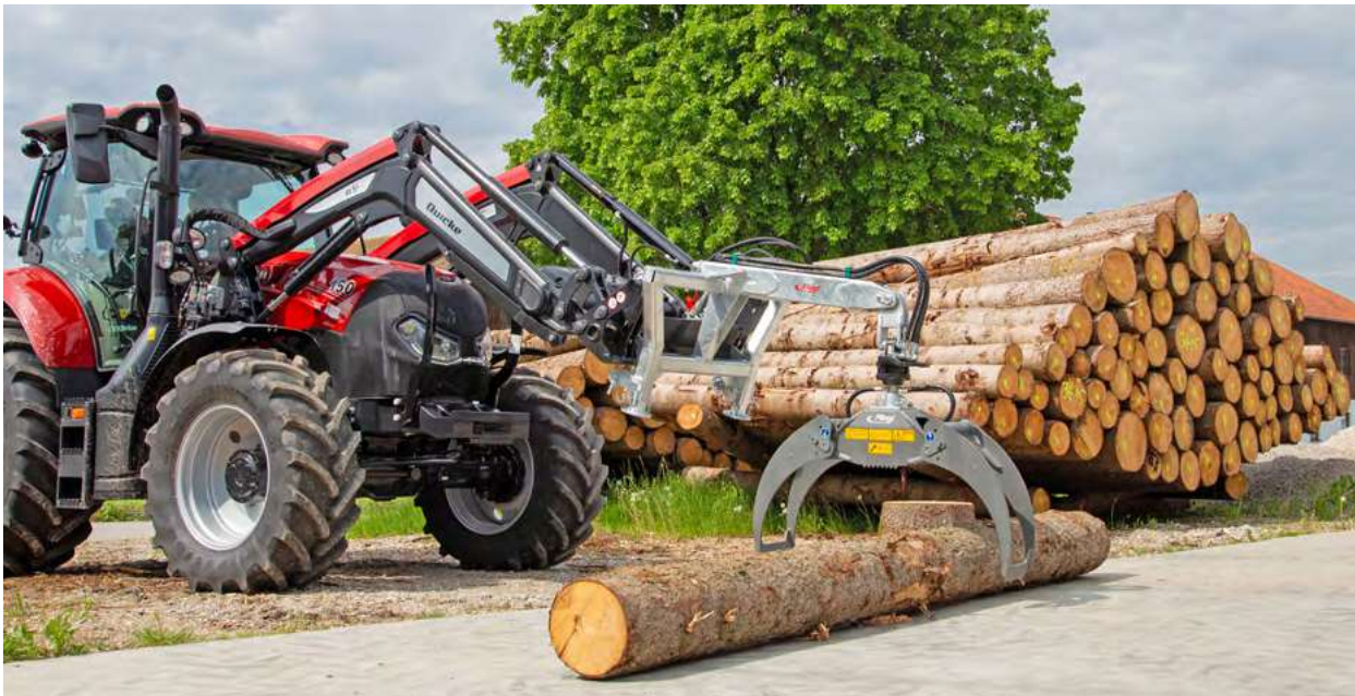
Verladezange mit Lasthakenverlängerung, Drehmotor, Euronorm- und Dreipunktaufnahme
