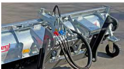
Mit Abstellfüßen und Schwerlast-Stützrädern
