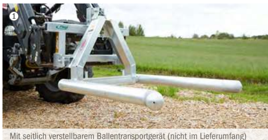
Mit seitlich verstellbarem Ballentransportgerät (nicht im Lieferumfang)
