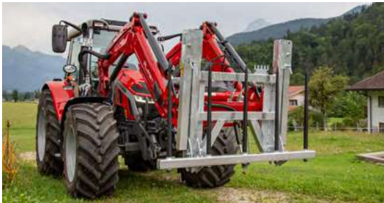
Nach oben geklappte Ballengabel – besonders kompakt
