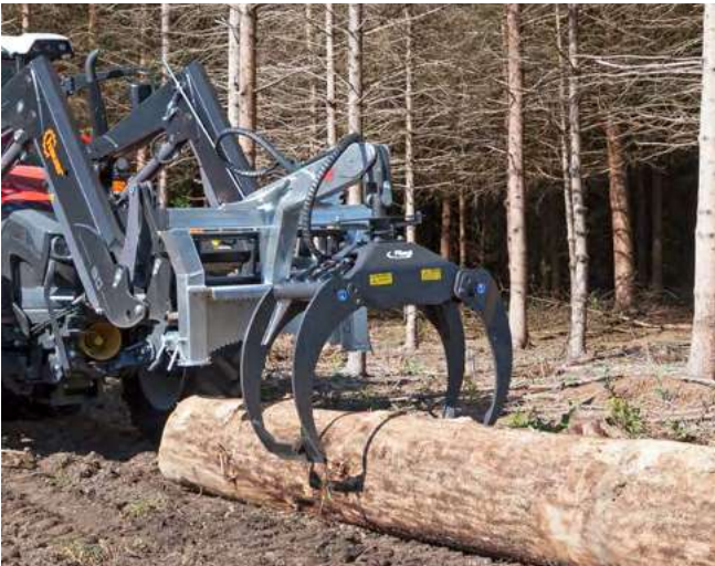
Hydraulische Rückezange »RZ 185 Combi« mit mechanischem Drehgelenk
