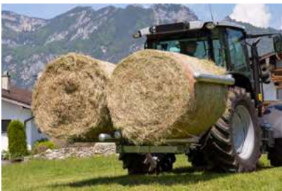
Arbeitsbreite 5-fach jeweils um 50 mm verstellbar
