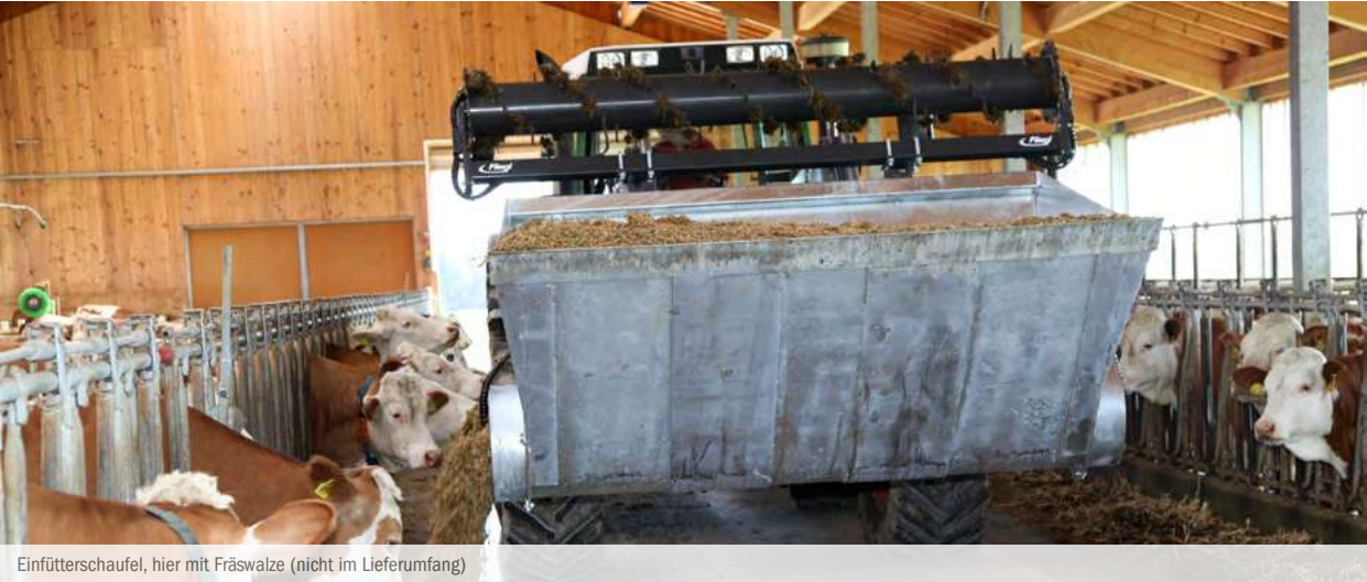
Einfütterschaufel, hier mit Fräswalze (nicht im Lieferumfang)
