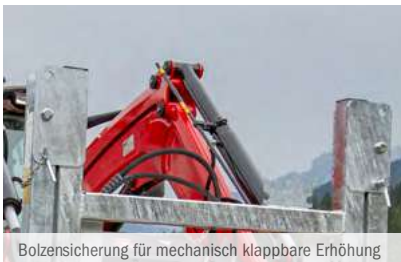
Bolzensicherung für mechanisch klappbare Erhöhung
