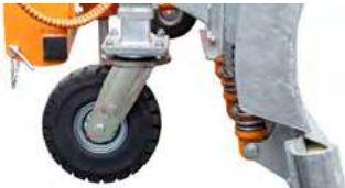
Schwerlast-Stützräder mit superelastischen Vollgummireifen: Ø 306 mm, Breite 105 mm, kugellagert, abriebfeste Lauffläche, schwere Drehkranzausführung, verstellbare Spindel
