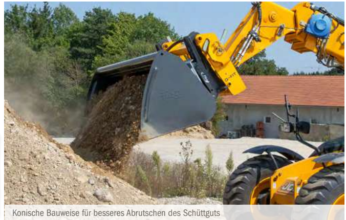
Konische Bauweise für besseres Abrutschen des Schüttguts
