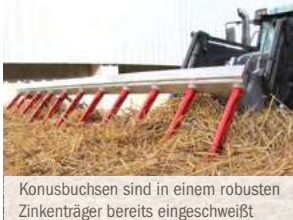
Robuste Schürfleiste schont den Schaufelunterbau
