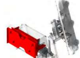
Überlastsicherung: Bei zu hohem Anpressdruck neigt sich zum Schutz vor Blockieren der Kopf nach hinten.
