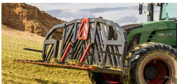
Abb. Siliegabel »Schwerlast« mit Aufsatzschneide für Maissilage
