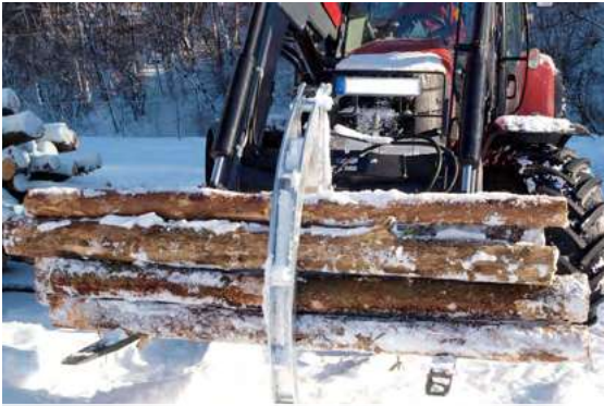
Hydraulischer Greifarm an der Kombi-Staplergabel »Freisicht« befestigt
