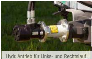
Hydr. Antrieb für Links- und Rechtslauf
