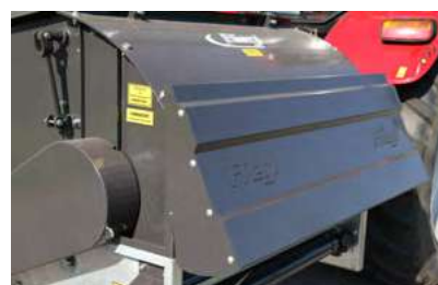
Hydraulischer Deckel – bester Schutz vor Verletzungen
