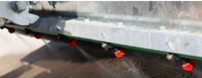
Sprüheinrichtung – die geschützt am Gehäuse angebrachten Spritzschutzdüsen versprühen das Wasser nah an der Bürste und verhindern Staubentwicklung
