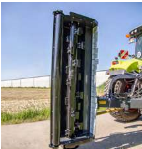
Extrem verschleißfeste Hammerschlegel
