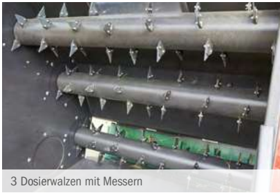
3 Dosierwalzen mit Messern
