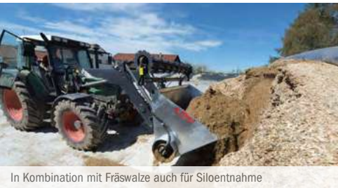
In Kombination mit Fräswalze auch für Siloentnahme
