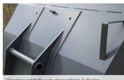
Orientierungshilfe zum ebenerdigen Aufladen von Schüttgut
