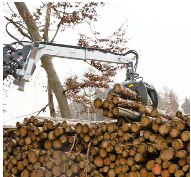
Hydraulische Rückezange »LongNeck Combi-Plus« mit Endlosdrehmotor
