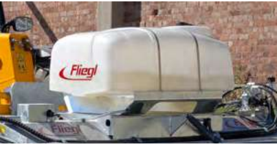
Tank 300 l für die Sprüheinrichtung
