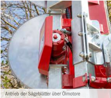
Antrieb der Sägeblätter über Ölmotore
