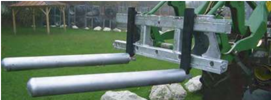
Aufsteckrohre für Rundballentransport mit Schrauben gesichert
