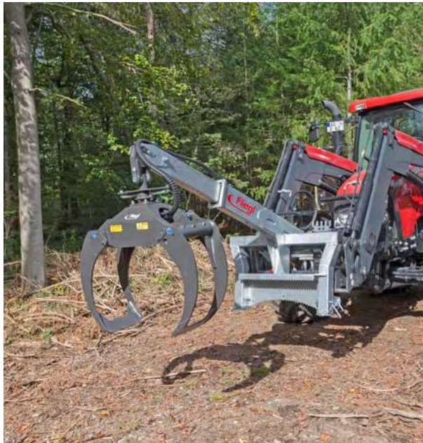
Hydraulische Rückezange »LongNeck Combi« mit mechanischem Drehgelenk
