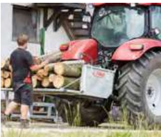
Ausklappbare Pendelwand dient als Wannenerlängerung
