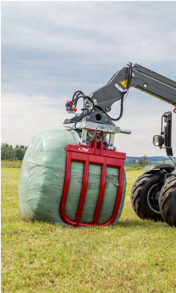
Sicherer Griff, ohne den Ballen zu beschädigen
