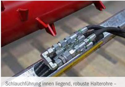
Schlauchführung innen liegend, robuste Halterohre – bester Schutz für Schläuche
