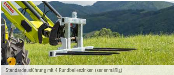
Standardausführung mit 4 Rundballenzinken (serienmäßig)
