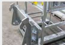
Beispiel: Arbeitsbühne mit schraubbarer Aufnahme für Claas Scorpion
