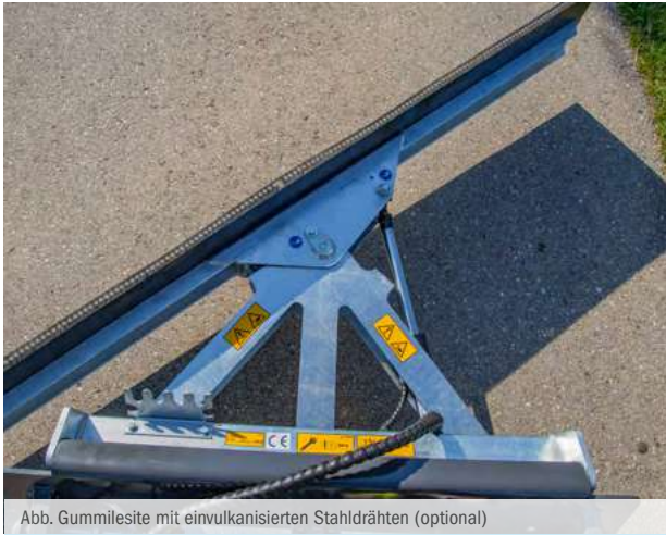
Abb. Gummileiste mit einvulkanisierten Stahldrähten (optional)
