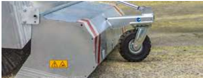
Schwerlast-Stützräder Ø 306 mm – superelastische Vollgummireifen, Breite 105 mm, kugellagelagert, abriebfeste Lauffläche, schwere Drehkranzausführung
