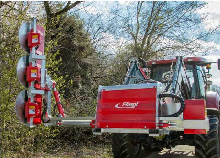
Flacher, speziell geformter Sägekopf für beste Sicht – ideal zum Schneiden von Sträuchern oder grobem Gestrüpp geeignet
