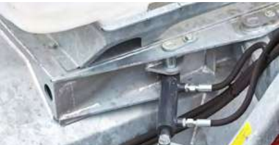
Hydraulischer Schwenkbock inkl. Bedienpult
