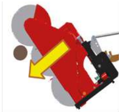
Hinweis: Starke Äste immer von oben nach unten schneiden, um ein Klemmen der Sägeblätter zu vermeiden!
