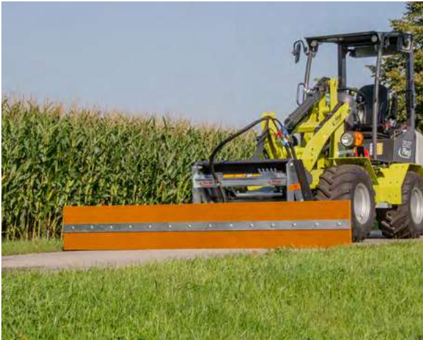
Abb. Gummileiste mit einvulkanisierten Stahldrähten (optional)
