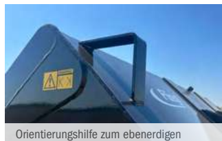
Orientierungshilfe zum ebenerdigen Aufladen von Schüttgut
