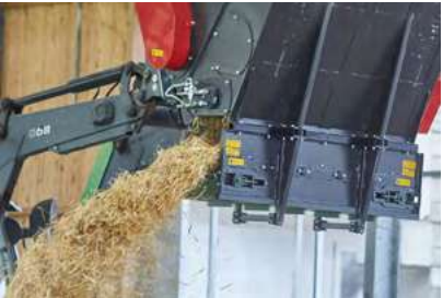
3 Dosierwalzen mit Messern
