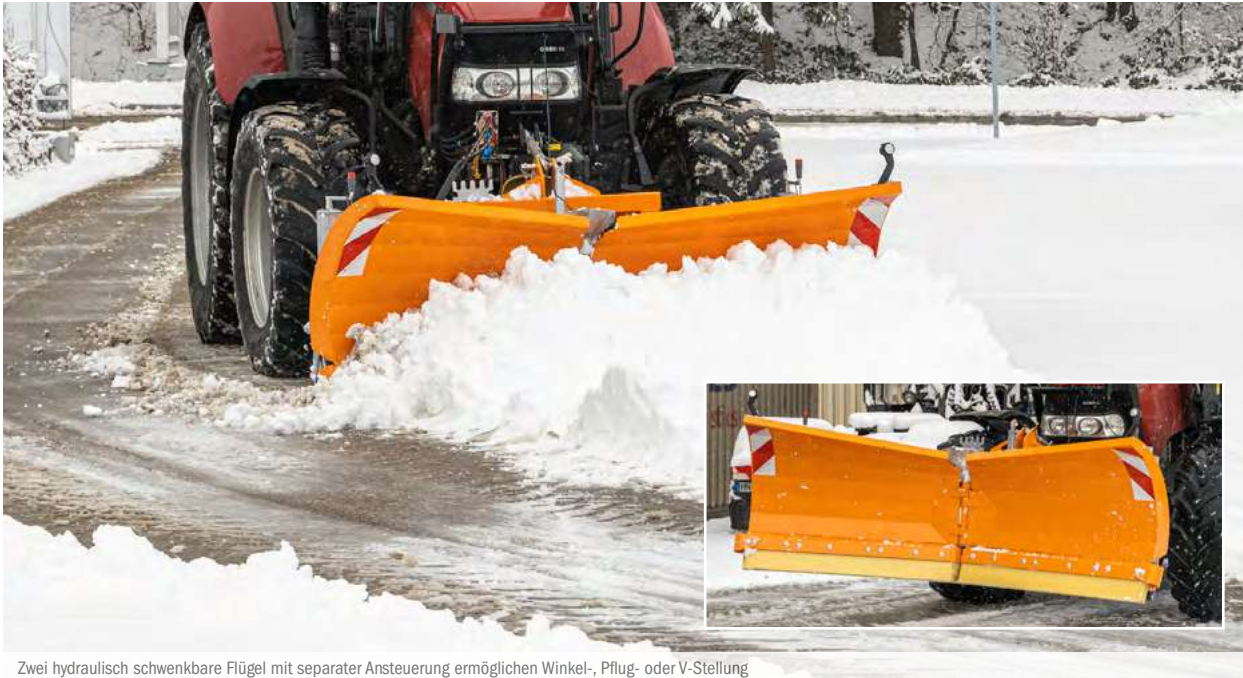
Zwei hydraulisch schwenkbare Flügel mit separater Ansteuerung ermöglichen Winkel-, Pflug- oder V-Stellung
