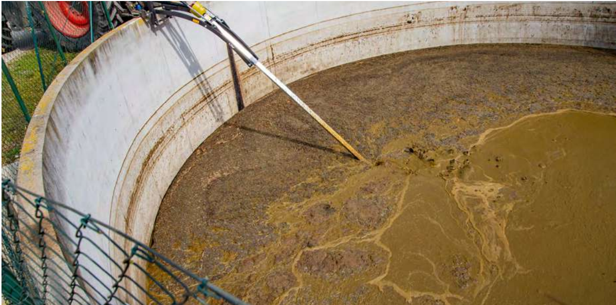
Mit hydraulischer Klappung – bei tiefen Gruben einsetzbar
