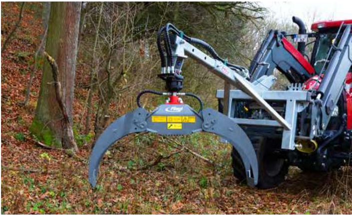
Verladezange mit Lasthakenverlängerung, Drehmotor, Euronorm- und Dreipunktaufnahme
