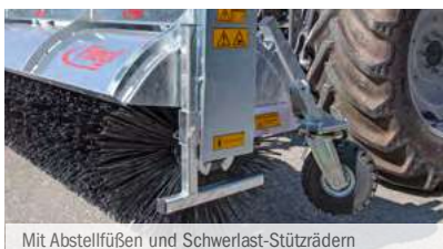
Mit Abstellfüßen und Schwerlast-Stützrädern
