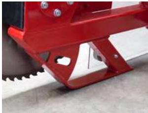
Schutzbügel verhindert Bodenkontakt des untersten Sägeblatts.
