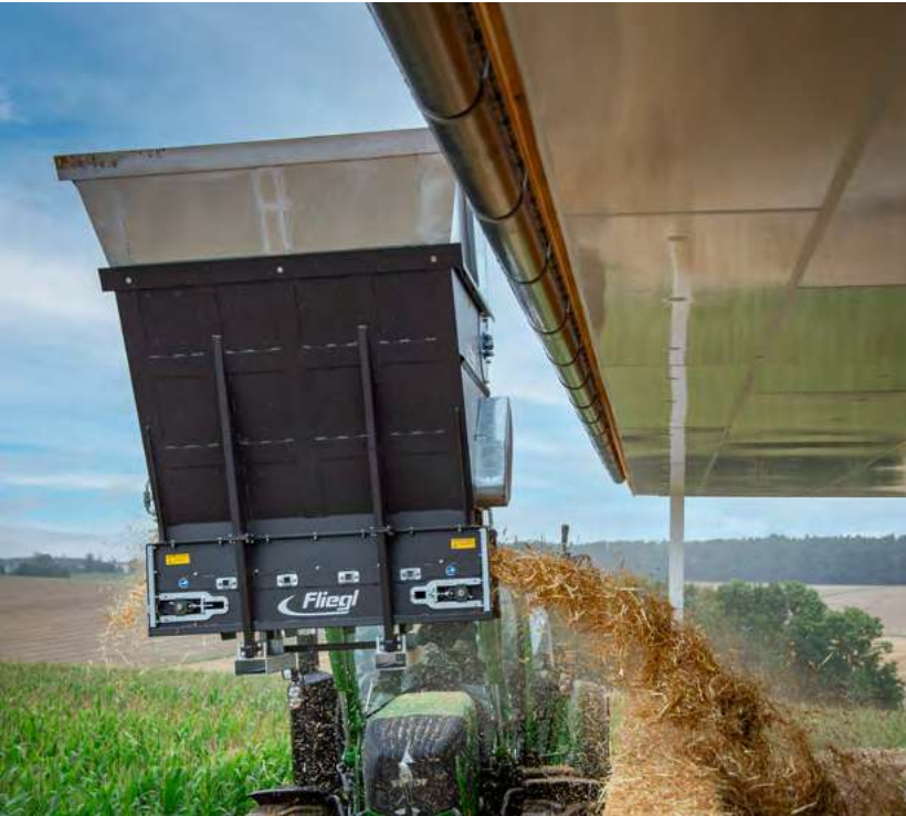
3 Dosierwalzen mit Messern
