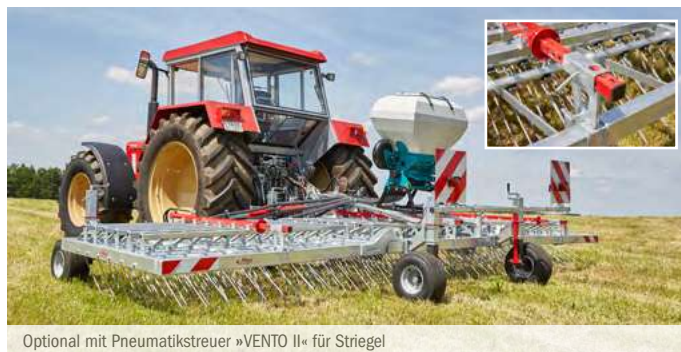
Optional mit Pneumatikstreuer »VENTO II« für Striegel
