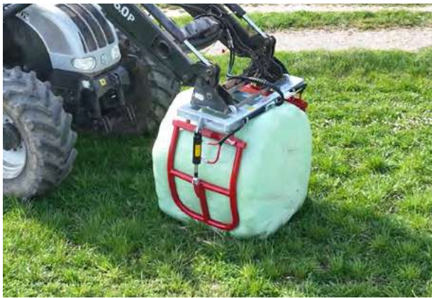
Sicherer Griff, ohne den Ballen zu beschädigen
