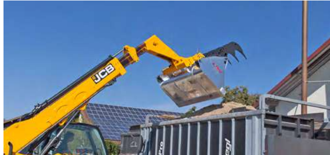
Zinken aus hochverschleißfestem Stahl HB 500 (Stärke 20 mm)
